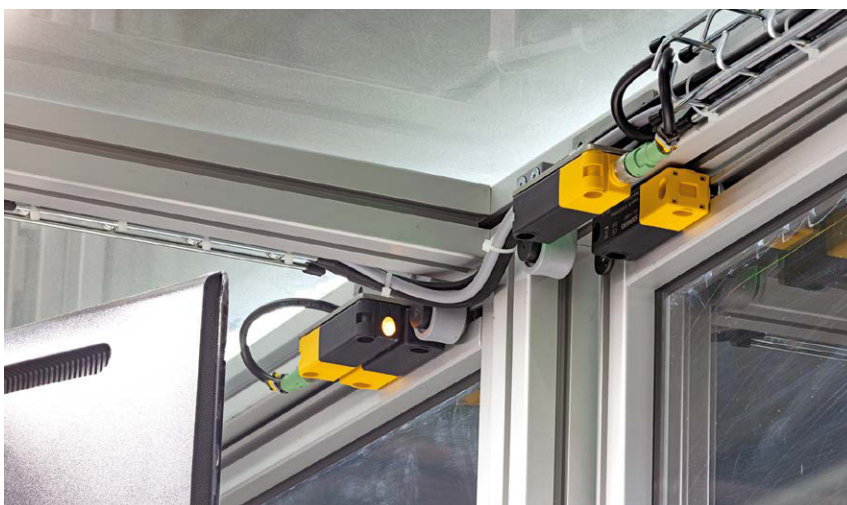
05 Die berührungslosen Sicherheitsschalter RFID mit maximalem Manipulationsschutz (3SE63) überwachen die Türen der Anlage zuverlässig
