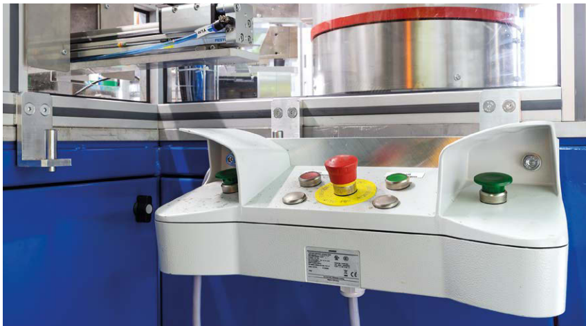
04 Das Zweihand-Bedienpult, ausgerüstet mit Befehls- und Meldegeräten Sirius Act, garantiert eine gefahrlose Bedienung der Maschine
